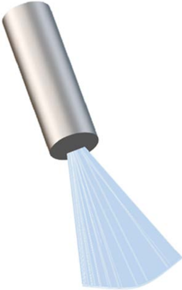
Kuva 14. Viuhkasuutin (mukaillen Hydroblast 2023; Safe Work Australia 2013, s. 15).
