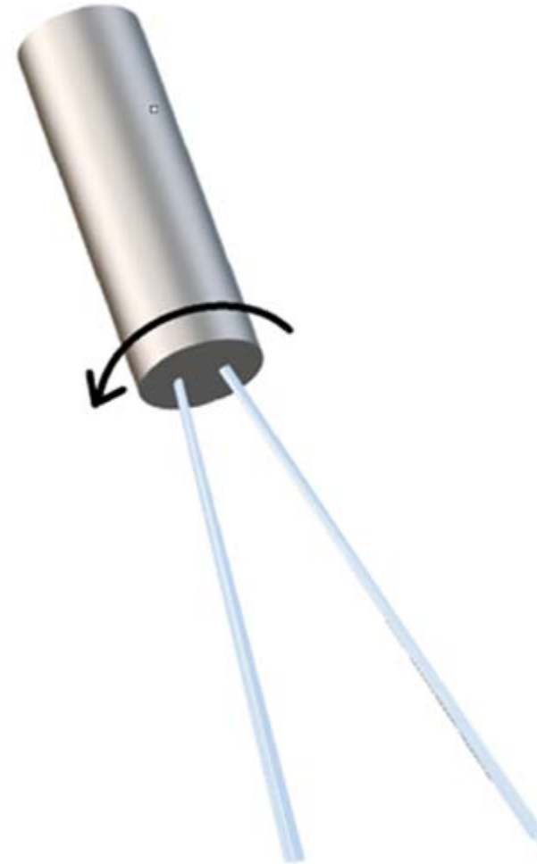
Kuva 15. Pyörivä suutin (mukaillen Hammelmann 2023; Safe Work Australia 2013, s. 15).
