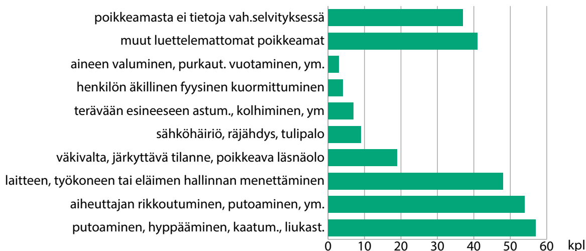
Kuvaaja 4. Työpaikkakuolemat v. 2009-2018 poikkeaman mukaan (Poikkeamalla tarkoitetaan viimeisintä vahingoittumista edeltänyttä poikkeavaa tapahtumaa). Kuvaajan tiedot esitetty talukoliitteessä 1D.
